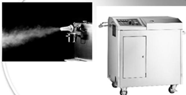
過熱蒸気発生装置
