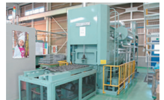
加熱の熱源に電気を採用した、真空雰囲気熱処理炉
