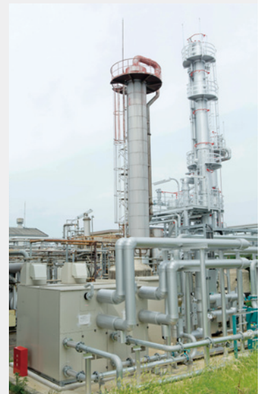
省エネルギー型メタノール蒸留システム 温水ヒートポンプ（左下）と 蒸留塔（右奥が新設備、左の旧蒸留塔は撤去予定）
