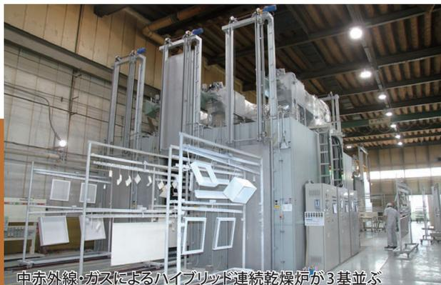
中赤外線・ガスによるハイブリッド連続乾燥炉が3基並ぶ
