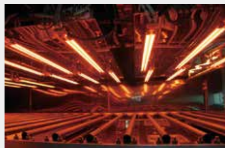
中波長カーボンヒータによる硬化
