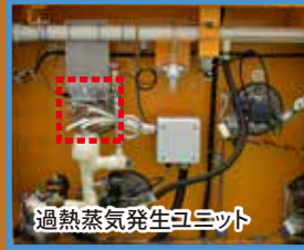
過熱蒸気発生ユニットを搭載したトンネルガスオーブン
