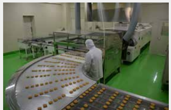
過熱蒸気による焼成を経て焼きあがった「武者がえし」
