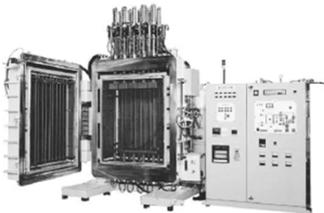
1953年の高周波ホットプレス1号機以来、多数の納入実績。加重100kgの小型実験設備から700トン超の大型生産機まで製作。連続式、多軸式、ノンフレイム型など、多様なニーズに対応した炉形式。
