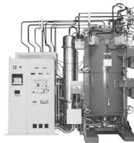
高圧雰囲気加圧から高真空まで対応可能。誘導加熱では3000℃の高温にも対応。抵抗加熱では常用2300℃で、メンテナンス性抜群の前割型や、横型・角形タンク式など様々な炉形式が選択可能。
