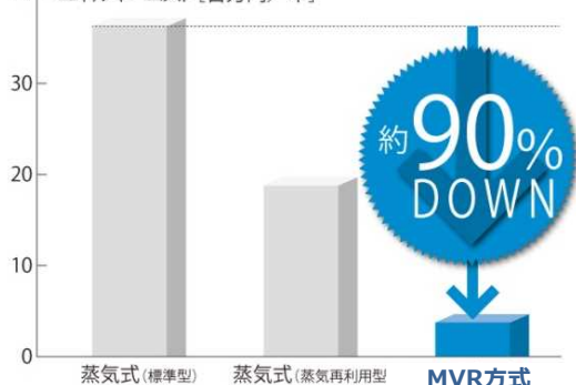
処理量50t/日の場合の エネルギーコスト比較 エネルギーコスト [百万円/年]
