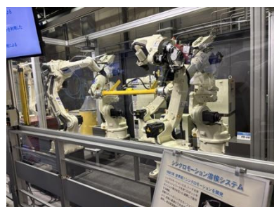
写真2 5台シンクロ溶接ロボ
