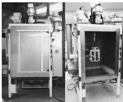
図 1 マイクロ波鋳型乾燥庫 (内寸 900 mm × 1200 mm × 900 mm)
