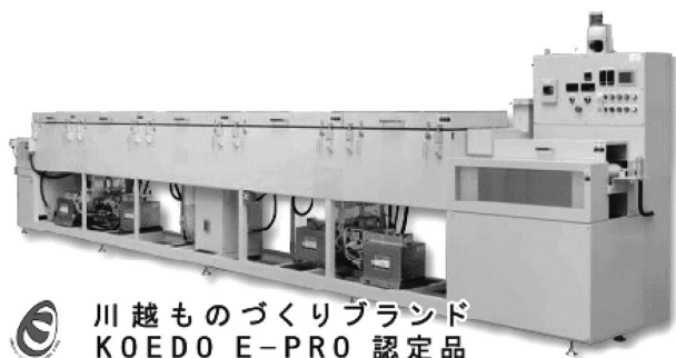
図1 マイクロ波ゴム連続加硫装置 (UHF)
