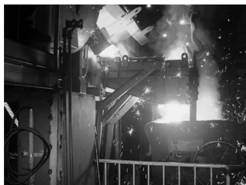
出湯中の5t 4,250kW 300Hz 中周波炉
