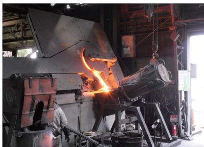
溶解風景。炉にセットされた坩堝から液体化した合金（溶湯）が流れる
