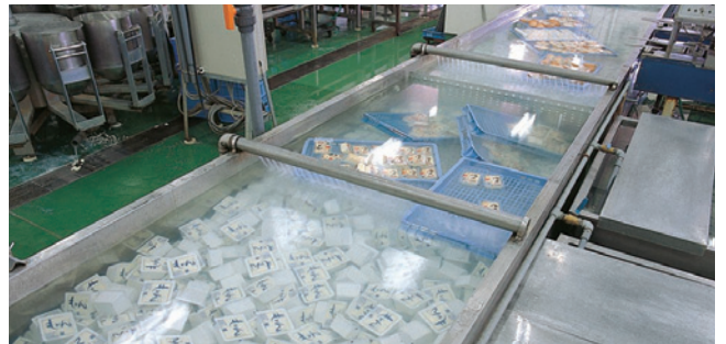
豆腐冷却水槽
