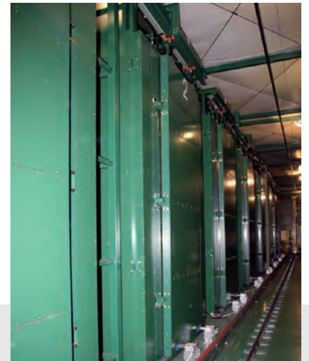
排熱回収型ヒートポンプにより温められた熱を利用して変圧器コイルを乾燥する装置(8基)
