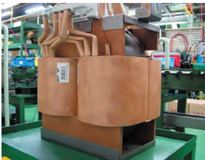
柱上変圧器コイル
