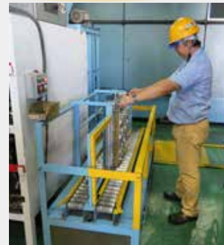
加熱装置への金型取り付け状況
