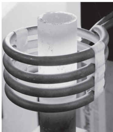
コイルは加熱工程に合わせ形状を工夫して設計
