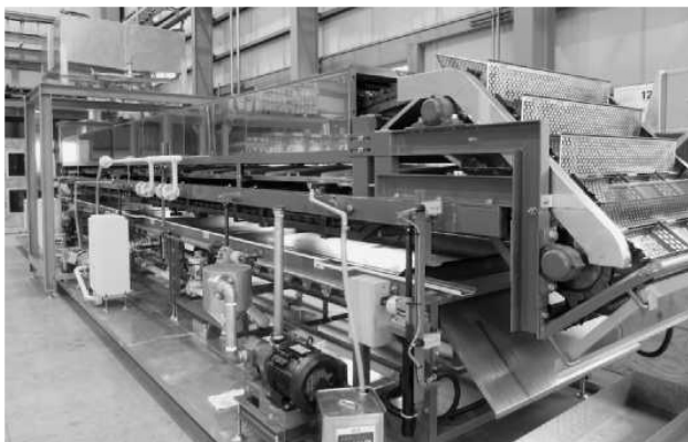
宏和機械工業が開発した電気式手揚げ風フライヤー。ふた付きの揚げ枠（手前）が奥に流れていく過程で薄揚げを安定生産する
